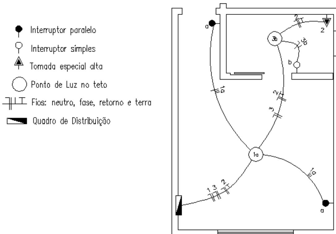
O projeto tem os circuitos 1 e 3 de iluminação, feitos com fio de 1,5 mm<sup>2</sup> e disjuntor de 10 A; o circuito 2 trata-se de um chuveiro, com potência de 6000W, fio de 4,0 mm<sup>2</sup> e disjuntor de 20 A.
