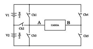
Este diagrama representa um inversor monofásico que utiliza cinco chaves semicondutoras. O braço esquerdo é formado pelas chaves Ch1, Ch2 e Ch3, sendo que somente uma delas permanece fechada enquanto as outras duas permanecem abertas. Já no braço direito, formado pelas chaves CH4 e CH5, enquanto uma está aberta a outra permanece fechada e vice-versa. Ou seja, se cumprem as seguintes tabelas de estados lógicos, onde "1" significa chave fechada e "0" significa chave aberta:
