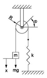
O momento de inércia da roldana em relação ao seu eixo de rotação é J e seu raio é R. Considere o sistema inicialmente em equilíbrio. A força gravitacional atuando sobre a massa m causa uma deformação estática na mola tal que  $kt \mid mg$ . Supondo que o deslocamento x da massa m é medido a partir da posição de equilíbrio, pode se afirmar que a freqüência natural do sistema é dada por:
