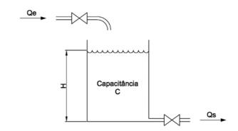
Considere que a vazão  $Q_s$  (m3/s) na saída está relacionada à altura H (m) por  $Q_s$  |  $0,01\sqrt{H}$  e que quando a vazão  $Q_e$  |  $0,020~m^3/s$  a altura H permanece constante. No instante t | 0 a válvula de entrada é fechada. Sabendo que a capacitância do tanque é de 1  $m^2$ , o tempo necessário para esvaziar o tanque a um quarto da altura original, em segundos, é de:
