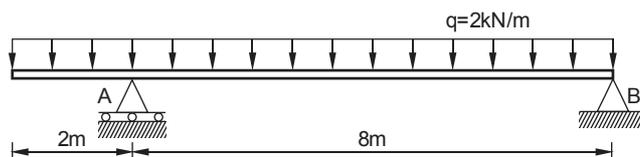
O valor do momento fletor em módulo, que traciona as fibras superiores no apoio A, em kNm, é
